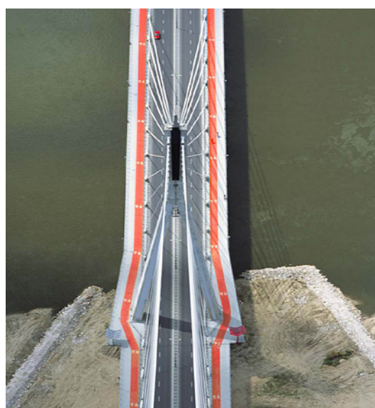
Most Świętokrzyski, zbudowany z rozwieszonych na pylonie 48 stalowych lin podtrzymujących płytę mostu.
