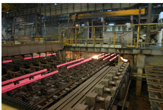
Proces ciągłego odlewania stali
